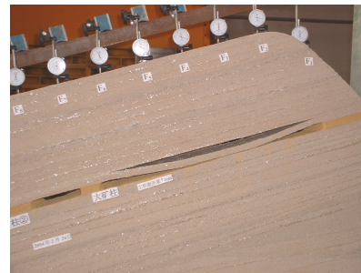
图 13 110 m 极限跨度时的覆岩破坏模型
