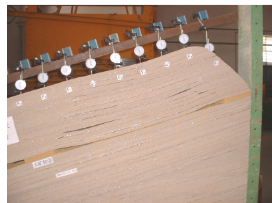
图 14 140 m 跨度时的覆岩破坏模型
